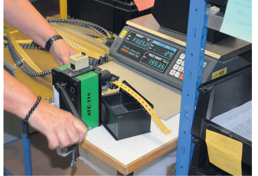
An der Römerstrasse in Zeiningen werden die Bauteile, die für die Netzteile benötigt werden, auf die richtige Länge geschnitten.
