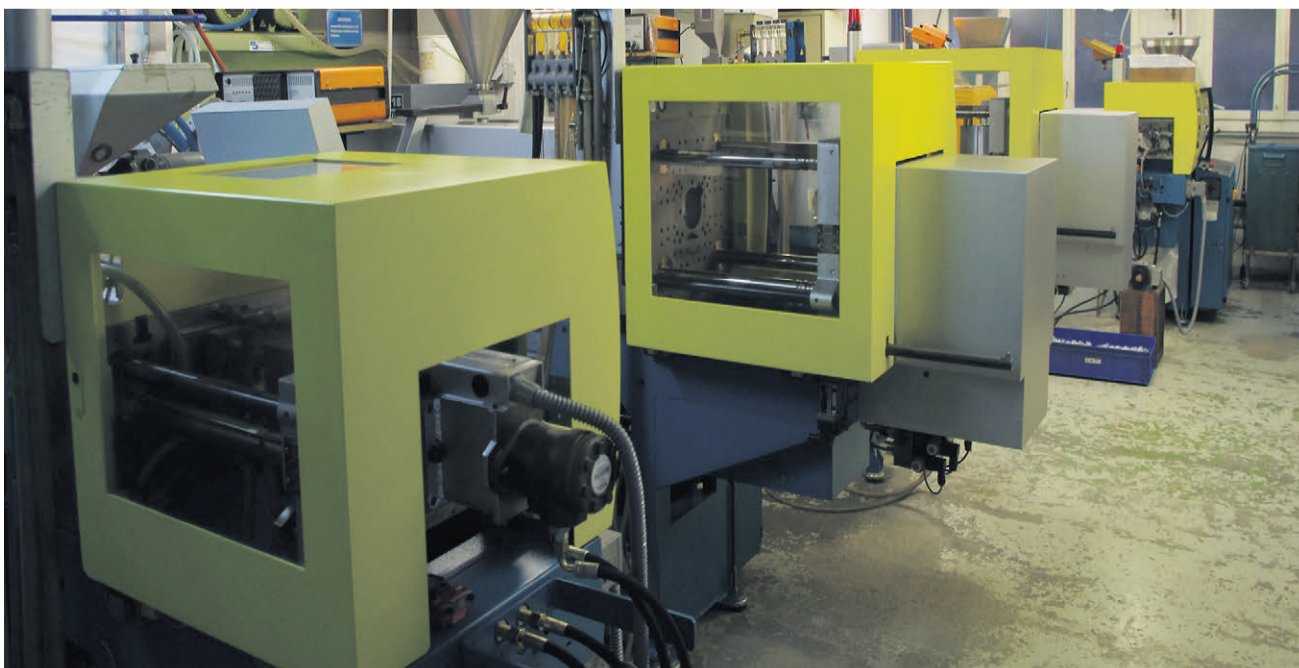
In diese Spritzgiessautomaten werden die Werkzeugformen eingebaut.
