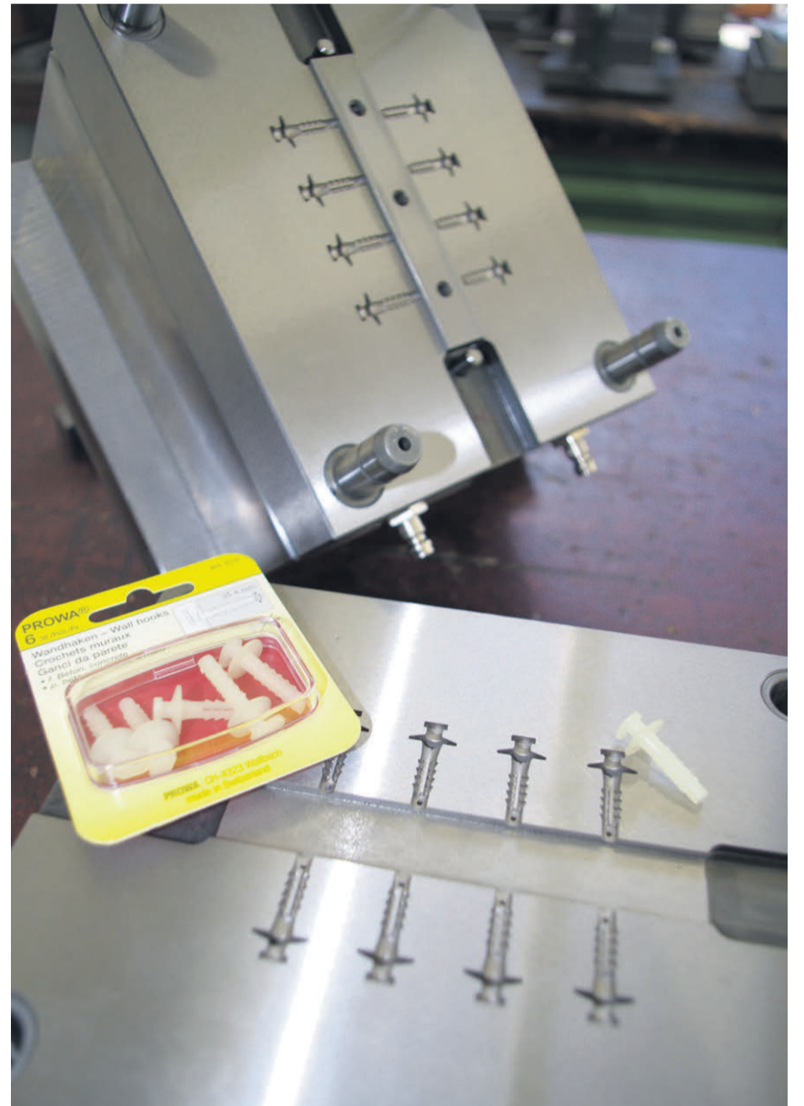
Präzision, millionenfach. Die beiden Werkzeugformen werden tonnenschwer gegeneinander «gestossen». In den eingefrästen «Hohlraum» (so genannte Kavität, lat. Cavum; dt. Höhle) wird der Thermoplastische Kunststoff eingespritzt. Das Produkt in diesem Fall: Wandhaken.
