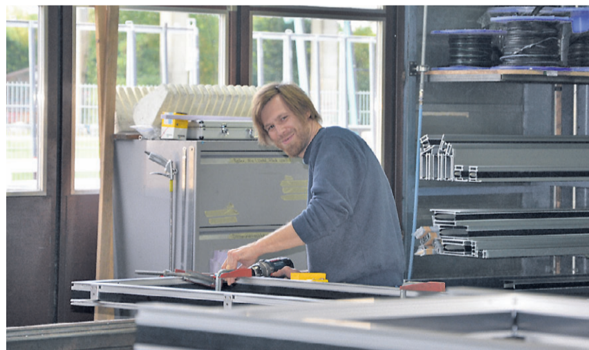
Metallbauer Roland Dietwiler baut einen Aluminium-Rahmen zusammen.
